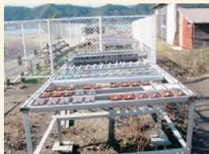
環境マテリアル研究所での大気暴露試験の様子
